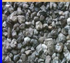
Steel slag waste
